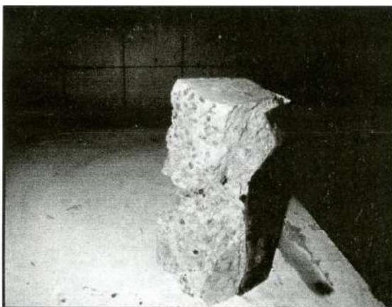
Figure 7 : État du béton après rupture du tube plein
